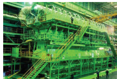
Slika A.15 Dvotaktni dizelski motor Wartsila-Sulzer RTA96-C s 14 valji je dolg 27 m in visok 13,5 m. www.wartsila.com
