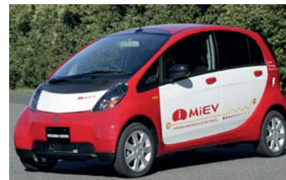
Slika 20.38 i MiEV proizvajalca Mitsubishi Motors Corporation. Ima 47-kilovatni motor, tehta 1080 kg in doseže hitrost do 130 km/h.
