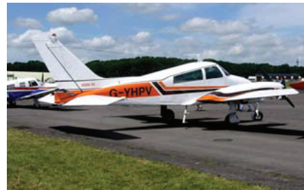
Slika C.9 Cessna 310N: 60 kWh na 100 potniških kilometrov. Cessna 310 Turbo s šestimi potniki (vključno z enim pilotom) in hitrostjo 370 km/h. Avtor fotografije: Adrian Pingstone.
