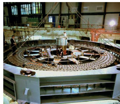
Slika 26.15 Gradnja enega od dveh vztrajnikov v fuzijskem raziskovalnem objektu v Culhamu. Foto: EFDA-JET. www.jet.efda.org .
