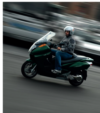
Slika 20.44 Vectrix: 2,75 kWh na 100 km. Foto: www.vectrix.com .
