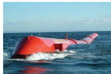
Slika 12.1 Zbiralnik valovne energije Pelamis je iz štirih delov sestavljena morska kača. Z nosom je obrnjen proti vstopnemu valovanju. Ob valovanju se kača pregiba, ob tem pa se v hidravličnih generatorjih ustvarja upor. Največja moč kače je 750 kW, na najboljših mestih v Atlantiku bi v povprečju zagotavljala 300 kW. Foto: Pelamis wave power. www.pelamiswave.com .
