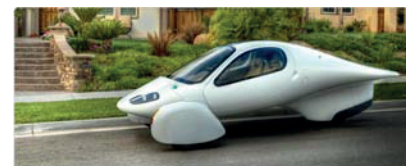
Slika 20.40 Aptera. 6 kWh na 100 km. Foto: www.aptera.com .
