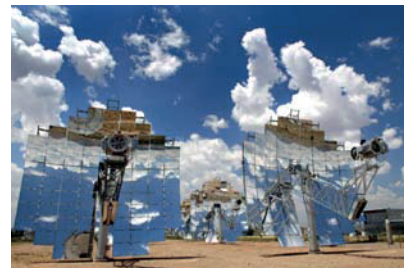
Slika 25.3 Paraboloidni koncentrador s Stirlingovim motorjem. Specifična moč teh prekrasnih koncentradorjev je 14 \text{ W/m}^2 . Fotografija objavljena z dovoljenjem Stirling Energy Systems. www.stirlingenergy.com
