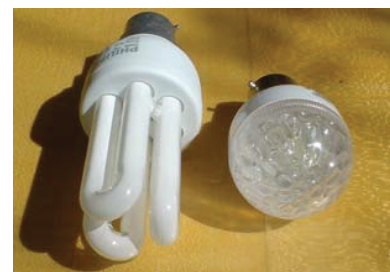
Slika 9.4 Philipsova 11-vatna sijalka in Omicronova 1,3-vatna LED sijalka.
