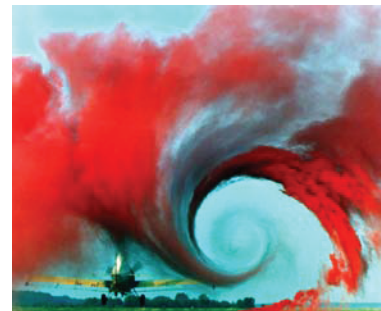
Slika C.4 Zračni tok za letalom. Vir fotografije: NASA Langley Research Center.
