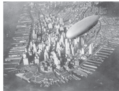
Slika C.14 239 metrov dolg zrakoplov USS Akron (ZRS-4) nad Manhattnom. Tehtal je 100 t, njegova nosilnost pa je bila 83 t. Skupna moč motorja je bila 3,4 MW, prevažal pa je lahko 89 oseb in kup orožja s hitrostjo 93 km/h. Uporabljali so ga tudi kot »zračno« letalonosilko.
