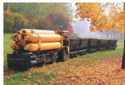
Slika 20.24 Zgoraj: Tramvaj na stisnjen zrak se v Nantesu polni z zrakom in paro. Za delovanje tramvajev so tam porabili 4,4 kg premoga (36 kWh) na km vozila oz. 115 kWh na 100 pkm, če so bili tramvaji polni. [5qhvcb] Spodaj: Lokomotiva na stisnjen zrak: masa 9,2 t, tlak 175 barov, moč 26 kW. Fotografije objavljene z dovoljenjem Rüdigerja Facha, Rolfa-Dieterja Reicherta in frankfurtskega Muzeja poljske železnice.
