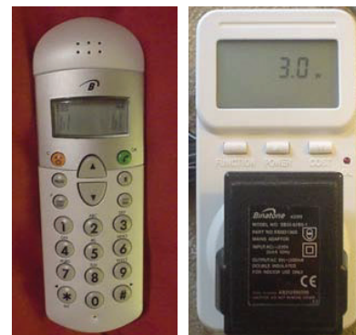
Slika 11.3 Ta potratni brezžični telefon in njegov polnilec potrebuje 3 W, če ju pustimo priključena. To pomeni 0,07 kWh/d . Če elektrika stane 10 penijev na kWh, 3-vatno curljanje stane 3 funte na leto.
