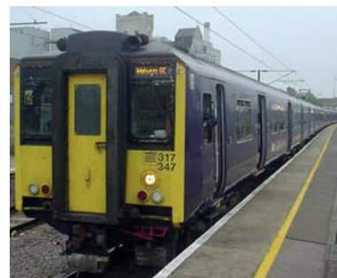
Slika 20.4 Ta 8-vagonski vlak pri največji hitrosti 100 mph (161 km/h) in polni zasedenosti porabi 1,6 kWh na 100 potniških km.
