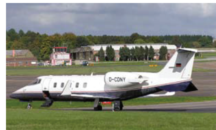
Slika C.10 »Pripnite si manšetne gumbe.« Letalo Bombardier Learjet 60XR z 8 potniki in hitrostjo 780 km/h porabi 150 kWh na 100 potniških km. Avtor fotografije: Adrian Pingstone.
