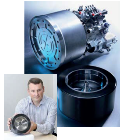
Slika 20.18 Sistem regenerativnega zaviranja z vztrajnikom. Fotografije objavljene z dovoljenjem Flybrid Systems.
