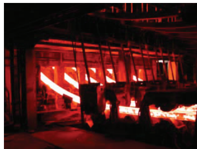
Slika H.1 Kontinuirano litje jeklenih trakov v obratu Korea Iron and Steel Company.
